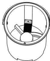
步骤 5:将搬运手柄对准中心轴线(如下图所示的内圆两个凹陷区域)插入桶内,并将手柄放回原位。
