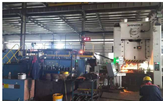
Línea de producción de forjado en caliente (2 líneas)
