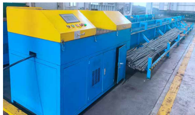
Línea de producción de corte automático para cables de anclaje para minería (3 unidades) Capacidad: 25 000 toneladas de cables de anclaje para minería al año
