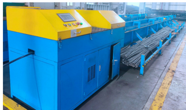
矿用锚索自动切割生产线 *3 套 产能：矿用锚索年生产能力 25000 吨
