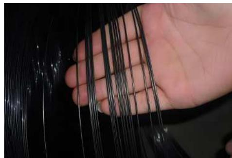
黑色退火线是一种通过加热和冷却处理后呈现黑色外观的线材。具有一定的韧性和耐腐蚀性，适用于多种工业和建筑领域。
