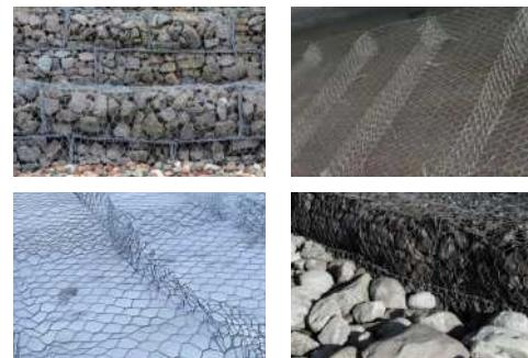
雷诺网又称“加强地网”或“撞击防护网”，是一种用于坡面防护、土石坍塌防治和加固工程的专用网格结构。它由高强度、低变形的钢丝经过机械编织或焊接而成，具有较高的抗拉强度和抗腐蚀性能，广泛应用于土工、交通、水利等工程领域。
