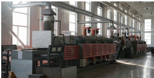
图：连续式热处理成产线
