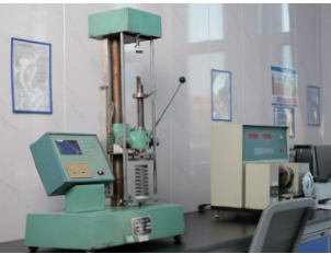
左：弹簧拉压试验机 右：扭转试验机
