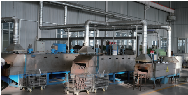
图：连续式回火炉
