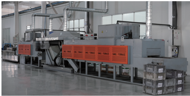
图：表面处理生产线（描述发黑生产线）
